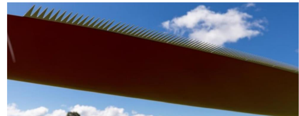
Figure 3 : Serration sur une pale d'éolienne
